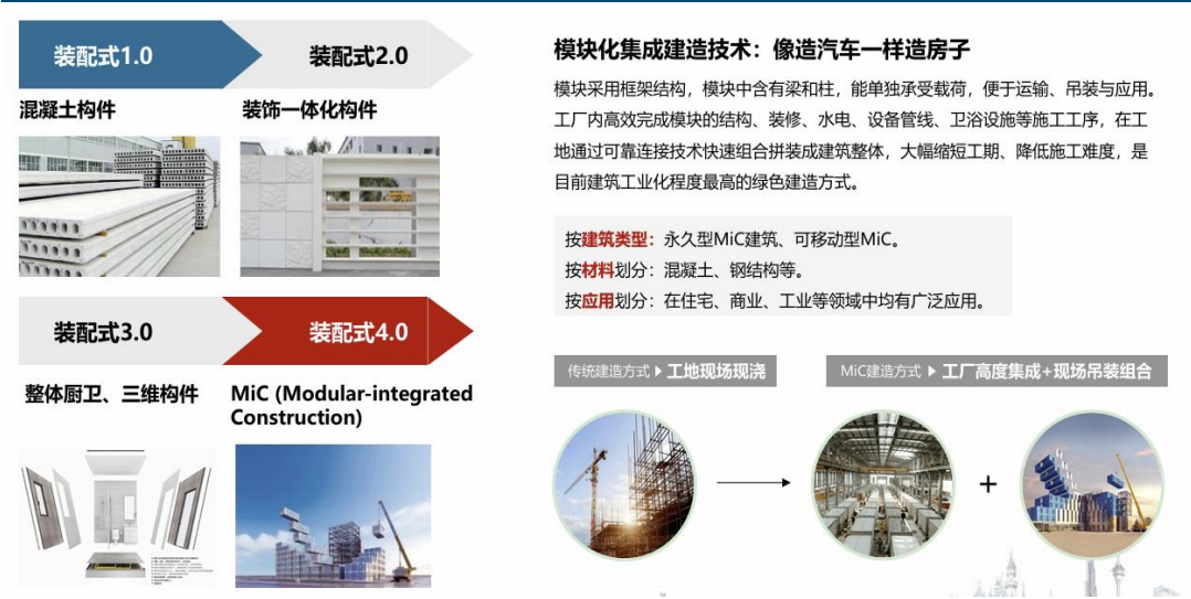
图表3: 模块化建筑改变传统建造方式
