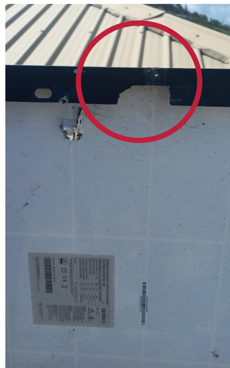
圣文森特岛在低循环条件下失效的模块框架。照片由 Fidel Neverson, RMI 提供
