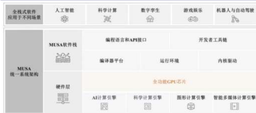
图表4：摩尔线程 MUSA 架构示意图
