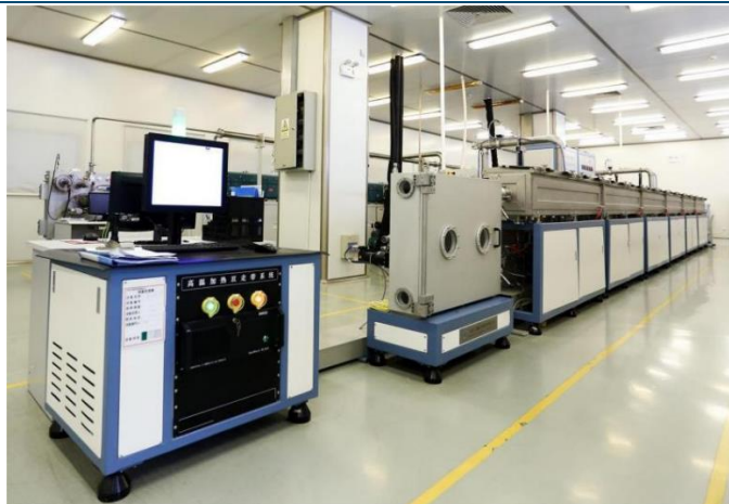
图表45：上创超导的超导层制作设备
