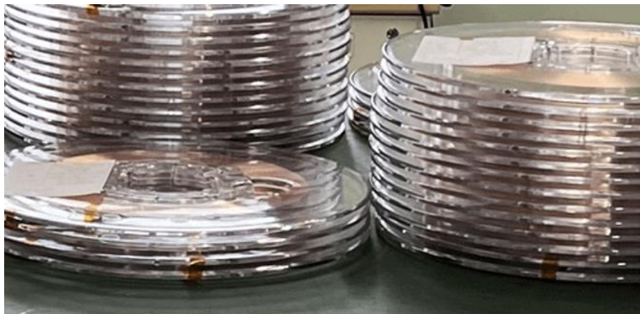
图表55：FFJ 的第二代高温超导带材
