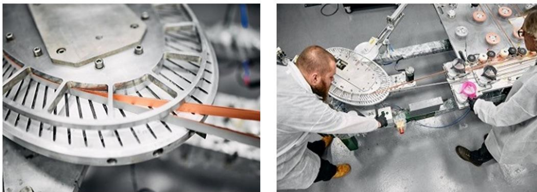
图表59: SuperPower 为英国 Tokamak Energy 生产的高温超导带材
