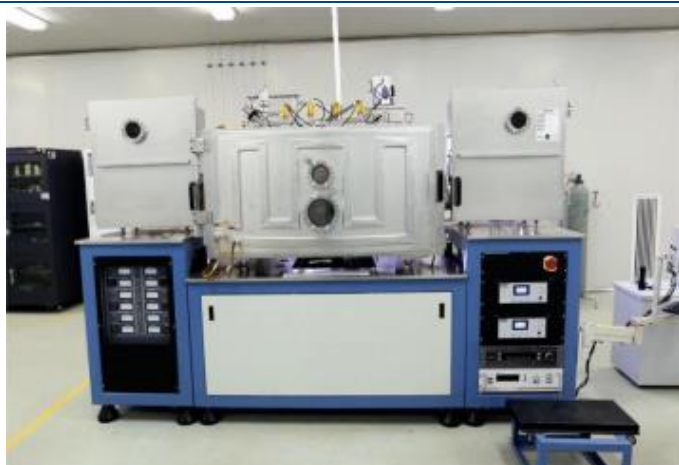
图表44：上创超导的缓冲层制作设备
