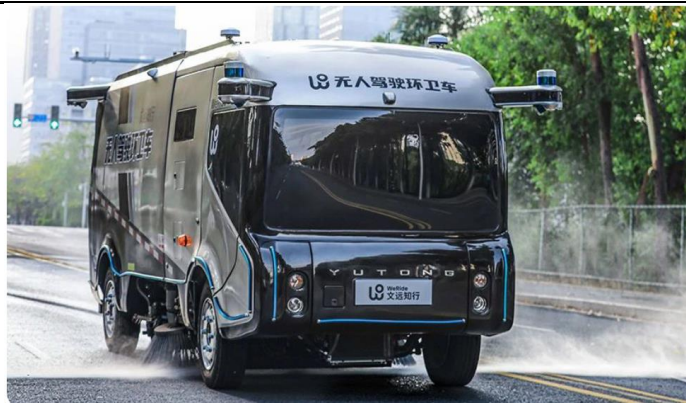
图 41：宇通重工自动驾驶洗扫车
