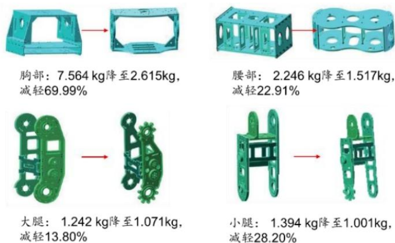
图：拓扑优化可大幅降低零部件重量
