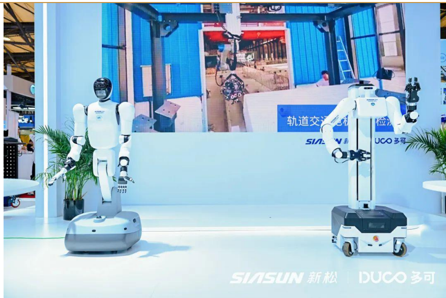
图 6：新松多可机器人——睿可系列 MR73A 轮式人形和 MR73B 升降人形机器人
