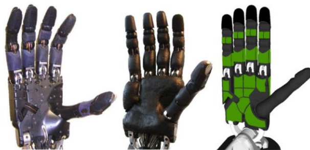
图4：特斯拉 Optimus 灵巧手表面集成触觉皮肤（绿色）
