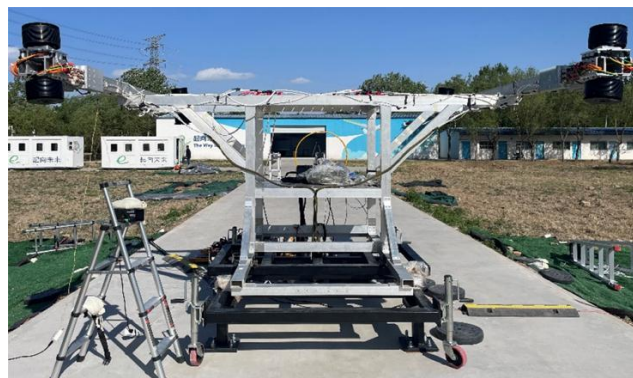
图 25：小功率典型规格完成所有台架及铁鸟测试
