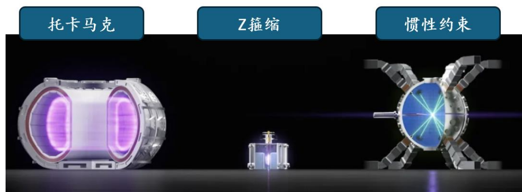
图表37: Z 箍缩聚变反应堆尺寸远小于托卡马克和惯性约束
