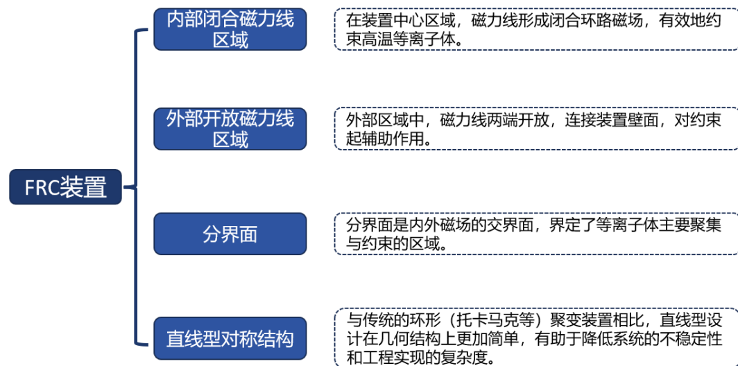
图表27: 场反位形 (FRC) 结构具备内部闭合、外部开放磁力线
