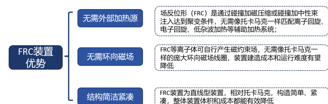
图表28: FRC 无需外部加热源和环向磁场、装置简单, 造价成本低和运行成本低
