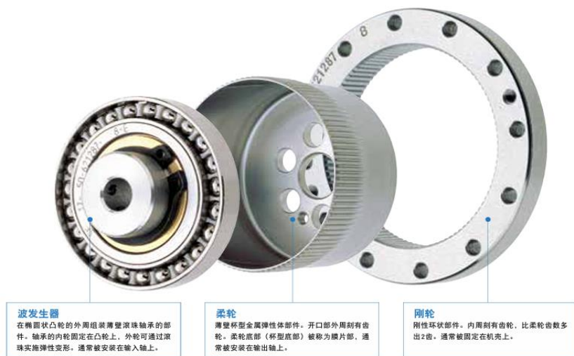
图：谐波减速器结构示意图
