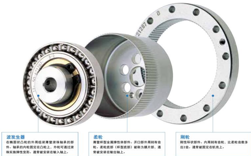
图：谐波减速器结构示意图
