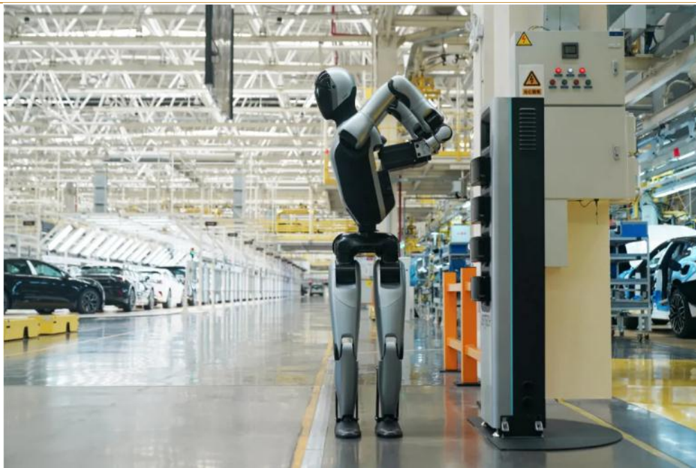
图 2：优必选 Walker S2 全球首个实现自主换电
