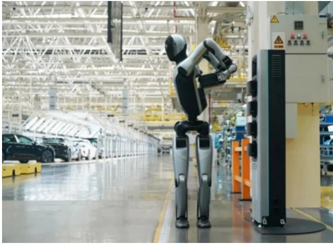
图4 可实现自主换电的优必选人形机器人 Walker S2
