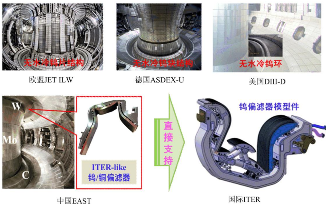
图表 7.磁约束聚变装置中的钨第一壁结构或设计模型件
