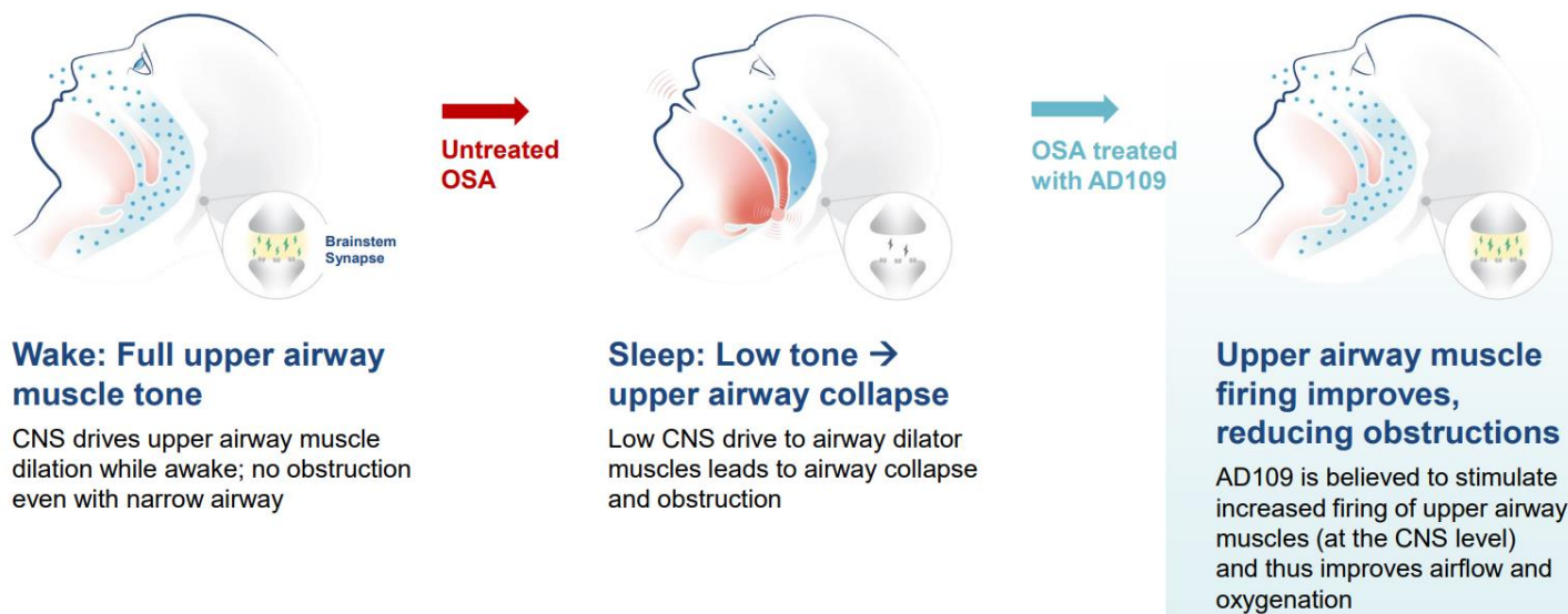
图表14: AD109 通过增加睡眠时呼吸道肌肉张力来治疗阻塞性睡眠呼吸暂停的作用机制
