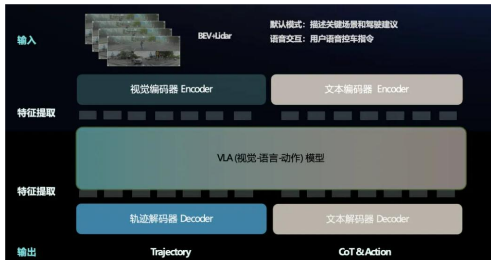
图：理想汽车VLA模型架构
