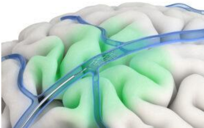
图表17：介入式脑机接口产品通过支架植入的方式收集电信号
