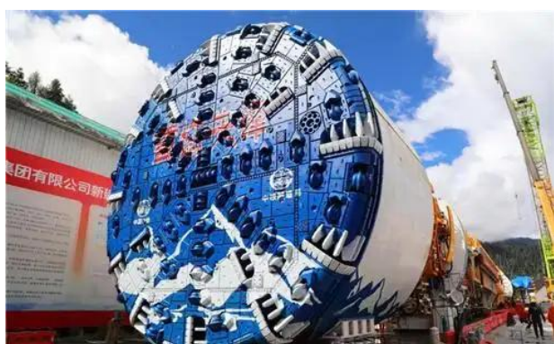
图13: 应用于高原高寒铁路的大直径 TBM “雪域先锋号”
