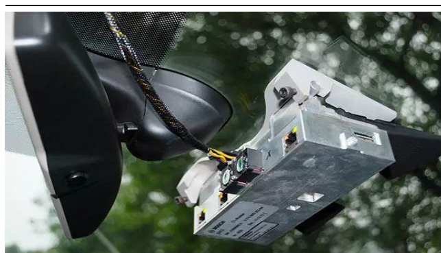
图13: 博世 AEB 采用双目摄像头和雷达结合的方案
