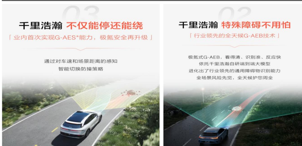
图16：极氪的 G-AES 结合了 AEB 和 AES，可智能切换避险策略，达成“边刹边绕”
