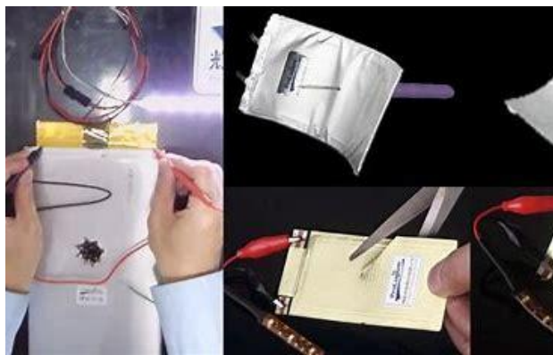
图表：固态电池不惧破损，剪开后还可使用
