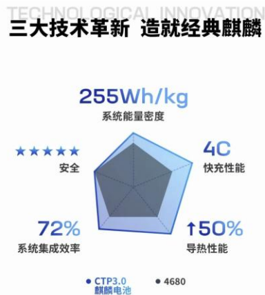
图表：宁德时代CTP3.0麒麟电池（能量密度255Wh/kg）
