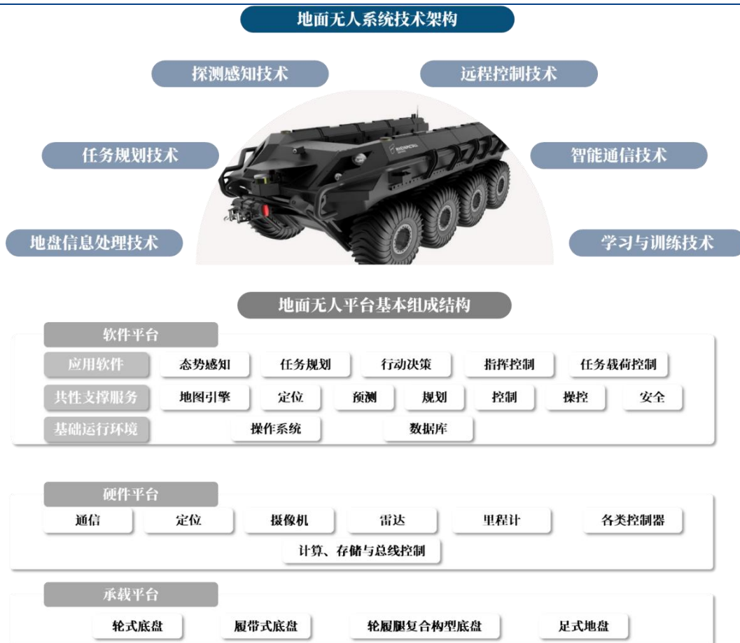
图4 地面无人系统技术架构及平台组成
