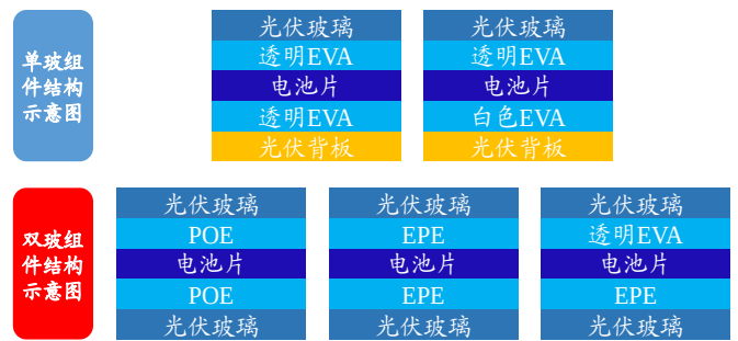
图21: 双玻组件可以进行双面光电转换
