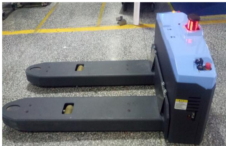
图：公司引进叉车式AGV小车及自主研发的调度系统节省人工搬运
