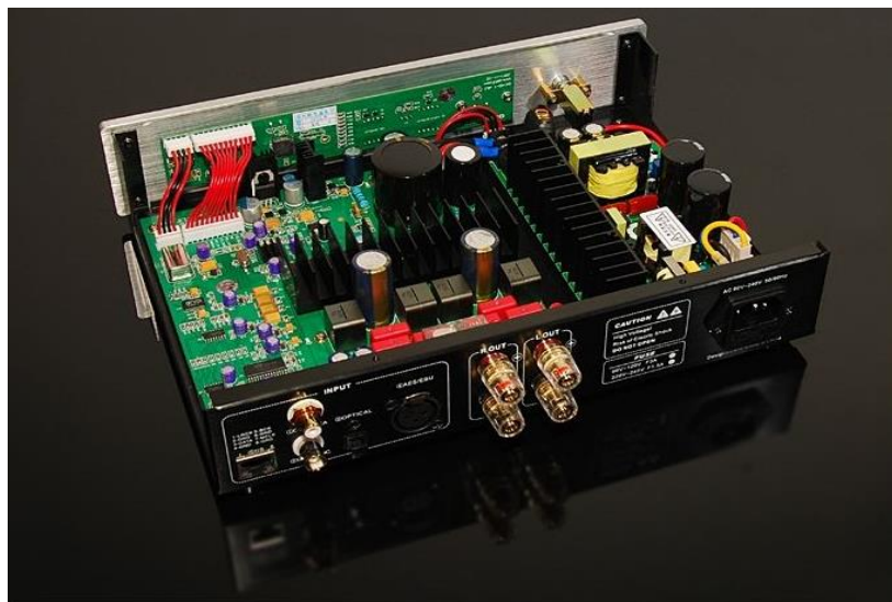
图：数字功放内部结构示意图
