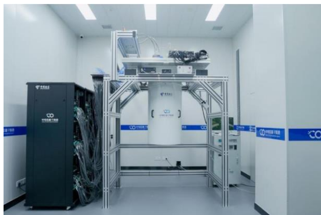
图表38：全国单台比特数最多的超导量子计算机“天衍 504”
