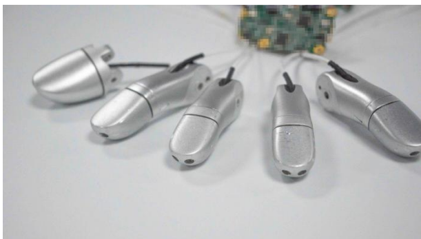
图 23：PhotonFinger-5in1 灵巧手精细力觉解决方案
