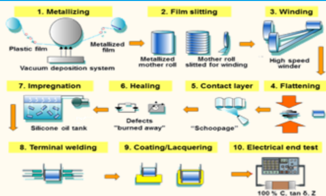
图表 2：金属化薄膜电容制造流程
