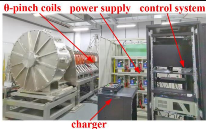
图60: FRC 装置主要由电源、磁体、真空室、控制系统等组成
