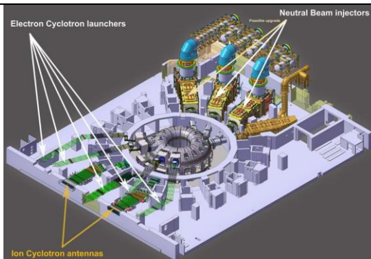
图33：ITER 射频波和中性束加热装置分布
