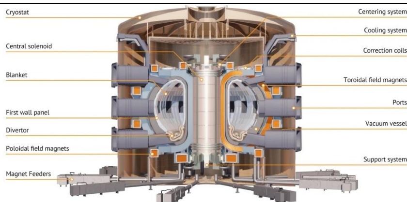
图25：托卡马克装置的主要组成部分包含真空室、磁体、包层、偏滤器、杜瓦等
