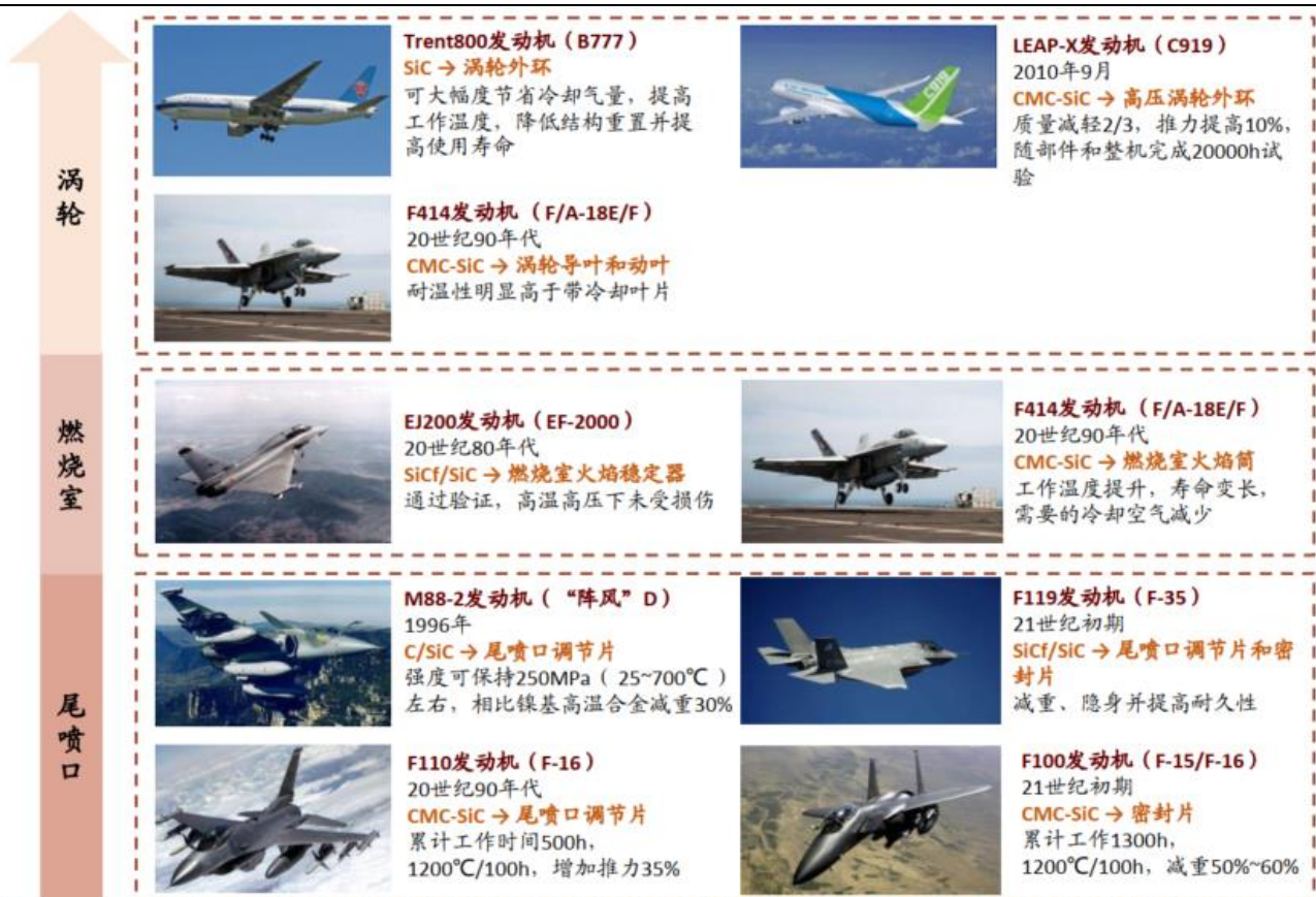
图表 211 陶瓷基复合材料在航空领域中的应用
