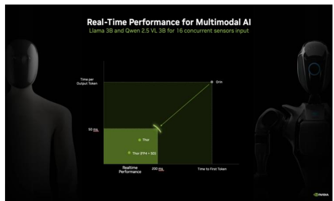
图表 7: Jetson Thor 在处理多模态人工智能的实时性能
