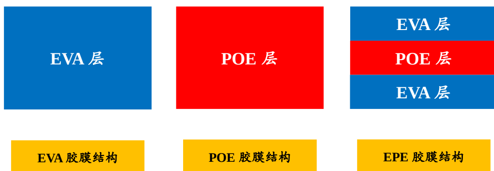
图4：光伏封装胶膜主要包括 EVA 胶膜、POE 胶膜、共挤型 POE 胶膜
