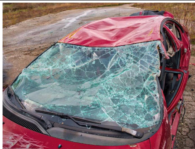
图9：车祸中前挡 PVB 夹层玻璃的破损程度
