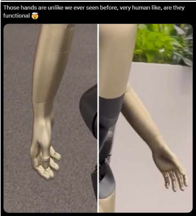
图2：特斯拉灵巧手向精细化、仿生化迭代，兼具灵活性与承载力
