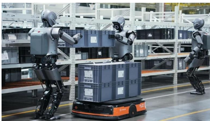
图18：优必选 WalkerS1 机器人在极氪工厂配合将重物搬至货架
