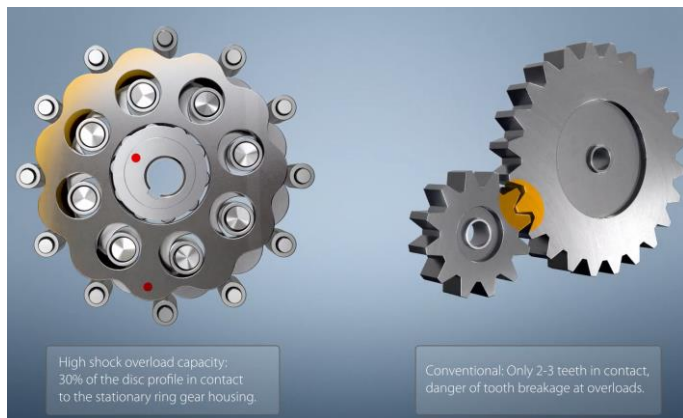
图12：摆线针轮通过多点接触均匀分载，较传统齿轮结构具备更强承载力和更长寿命
