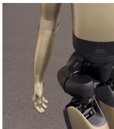
图14：金色版 Optimus 中推出高度拟人的灵巧手，灵巧手是 Gen3 方案迭代强确定性重点
