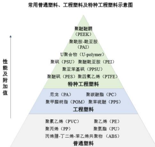
图9：PEEK 材料性能处于工程塑料的顶端，具有机械特性好、耐高温、轻量化等优势
