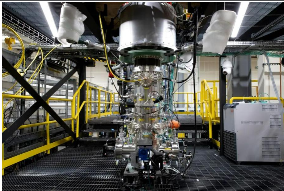
图16：ZAP Energy 的 Z 箍缩等离子体腔室
