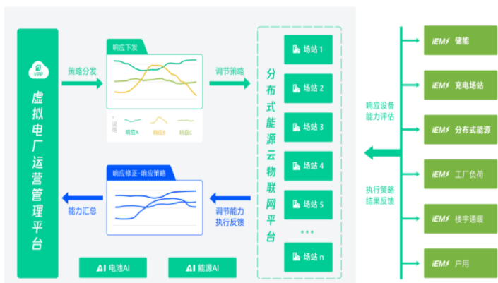
图 24：虚拟电厂结构示意图 2
