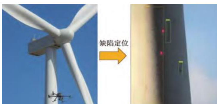
图 15：海上风电机组无人机叶片巡检
