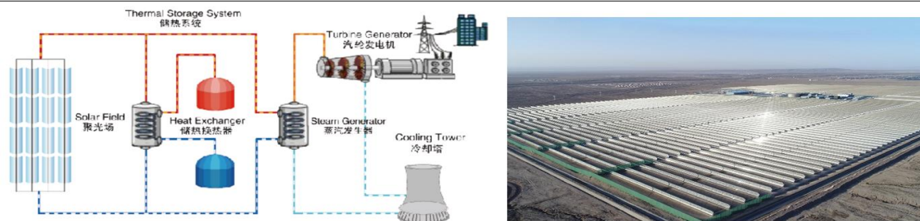
图2：槽式光热发电利用聚光镜将太阳光聚焦到集热管上
