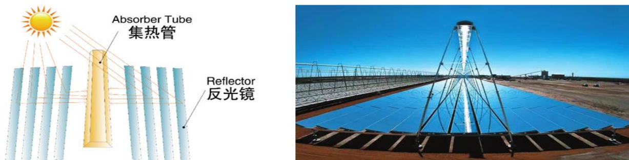
图3：线性菲涅尔式光热发电将太阳辐射聚集到吸热管
