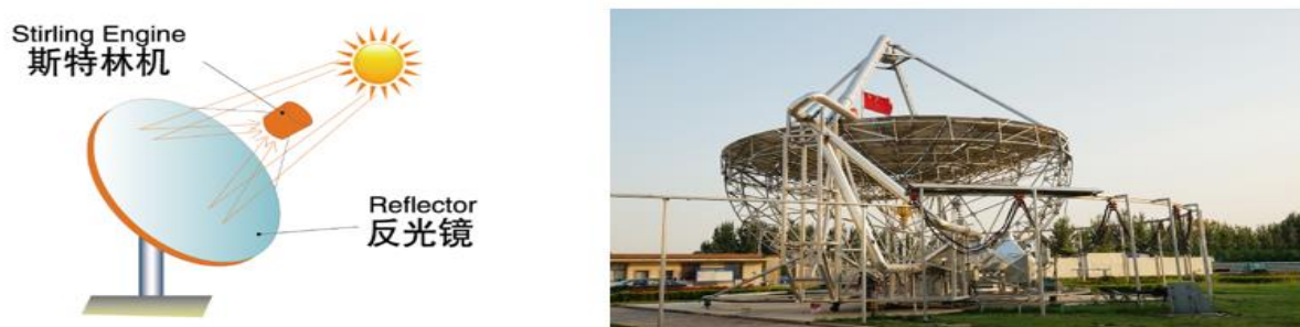
图4：碟式光热发电利用碟式聚光器将太阳光聚集到吸热器
