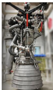
“苍穹”可重复使用液氧/ 煤油发动机
