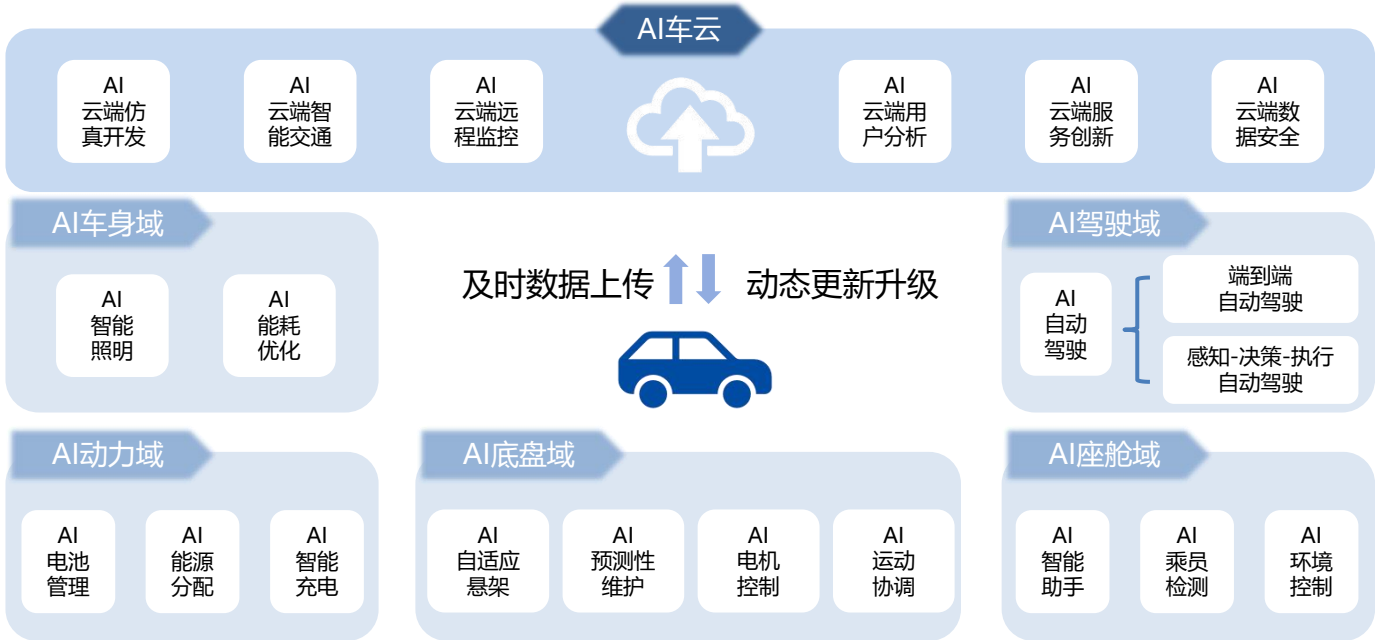
智能汽车云端与域控制器的功能交互示意
