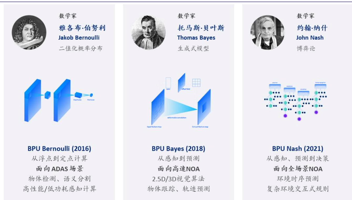
图表 127：地平线 BPU 架构随着自动驾驶的技术演进而持续进化
