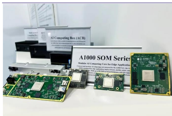
图表 189：黑芝麻智能在 ATxSG 上面向机器人的方案：基于 A1000 及 C1200 家族芯片的 SOM 板
