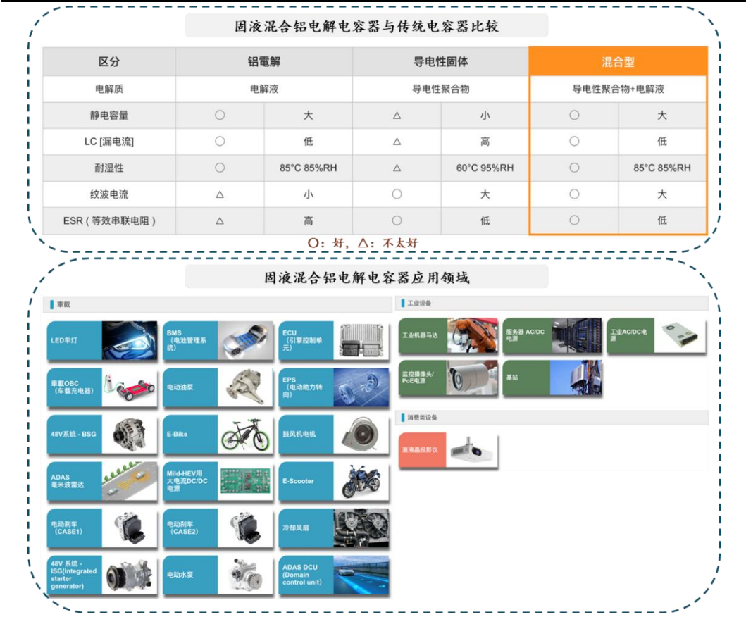
图18：固液混合铝电解电容器与传统电容器比较及应用领域
