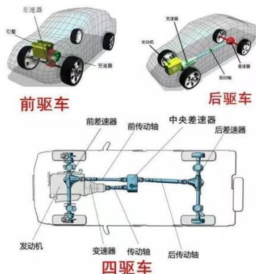
图 15：前驱、后驱、四驱车型结构图
