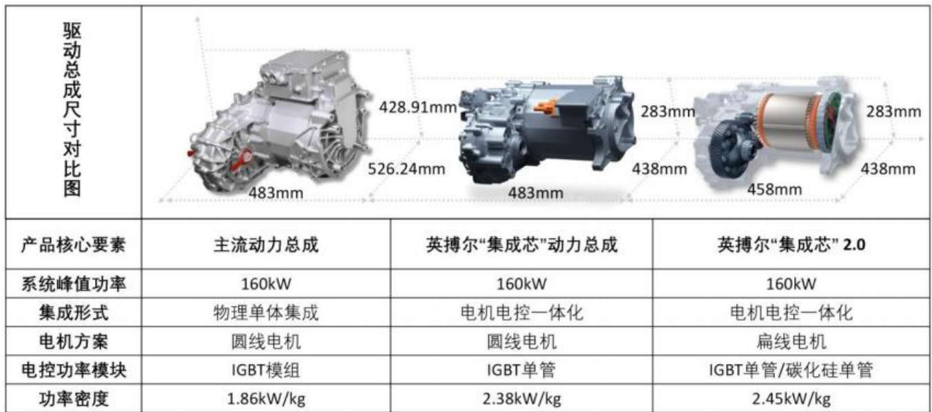
图21：公司“集成芯”动力总成产品采用单管方案，功率密度参数领先
