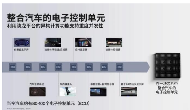
图 35：高通第三代智能座舱平台整合 ECU 方案
