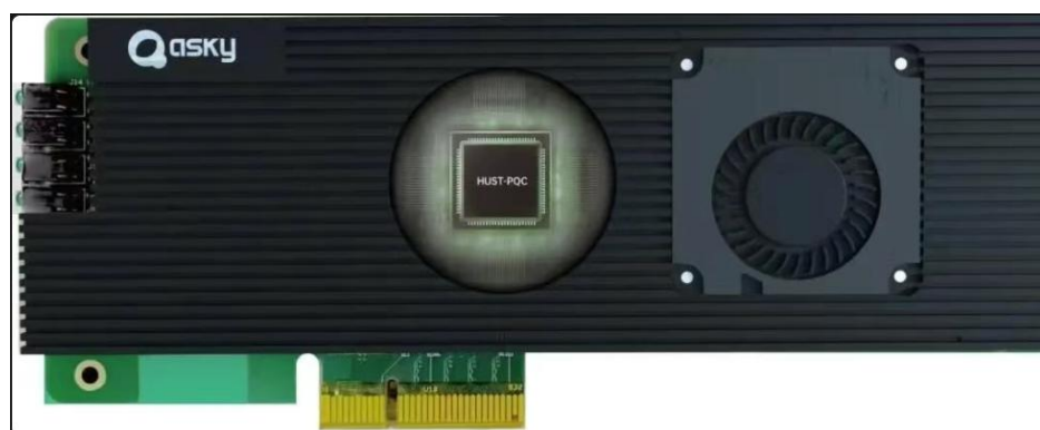
图13：芯片级后量子密码卡实物图
