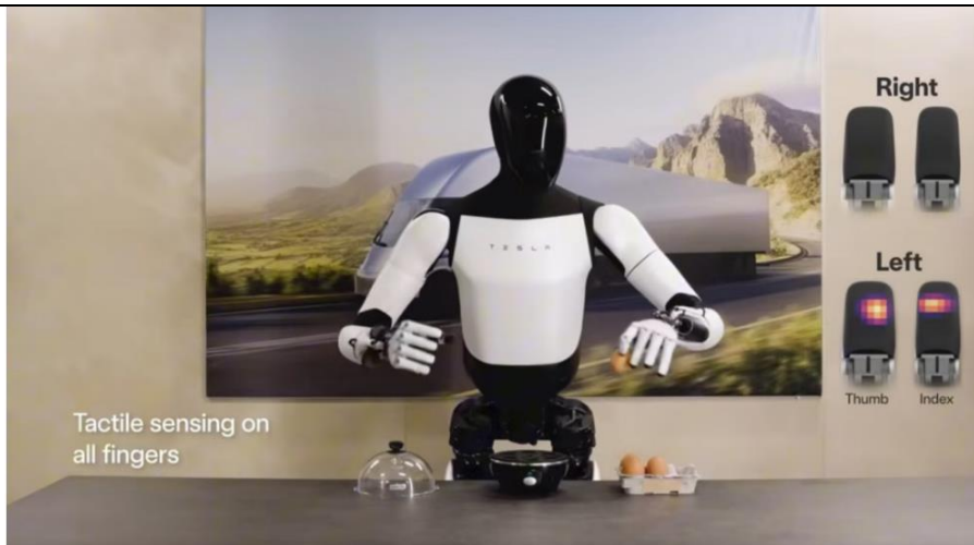
图6：Gen2 灵巧手新增触觉传感器，Gen3 有望集成视触觉
