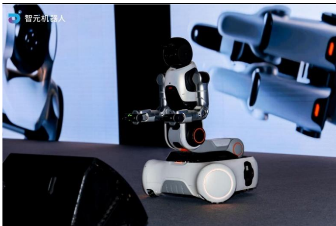
图8：智元发布轮式双臂机器人灵犀 X2-W，配备三指灵巧手及触觉反馈
