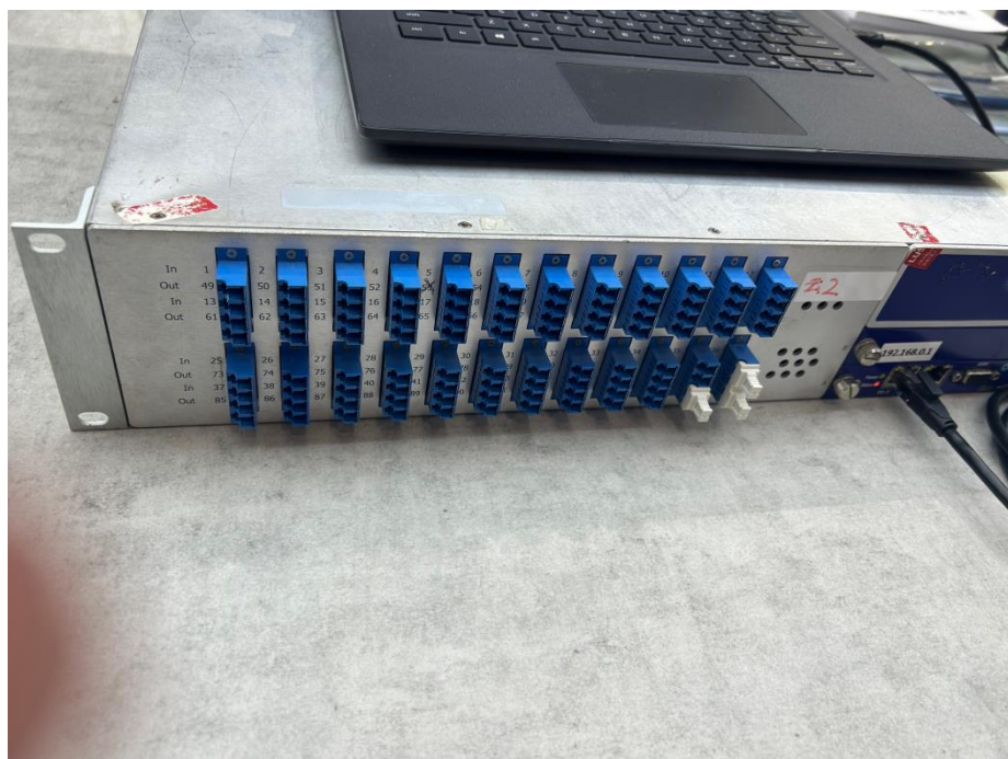
图10：凌云光 48 端口压电陶瓷 OCS 光交换机
