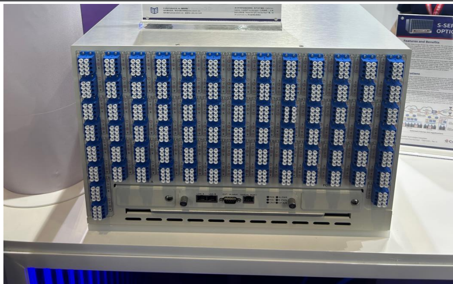
图8: 光库科技与 Calient 合作的 320 端口 MEMS 光交换机
