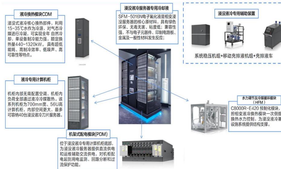
图33：C8000 液冷机柜构成图
