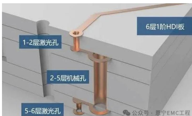
图4：PCB 板钻孔分为机械钻孔及激光钻孔
