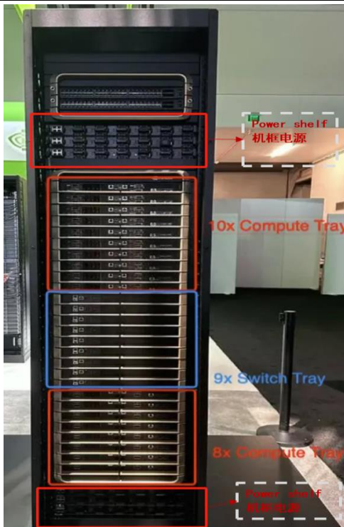
图14: NVL72 配置机框电源
